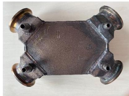
Abb. 2: gefertigter Wärmeübertrager
