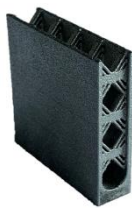
Abb. 1: additiv hergestellte Wärmeübertragungsstrukturen
