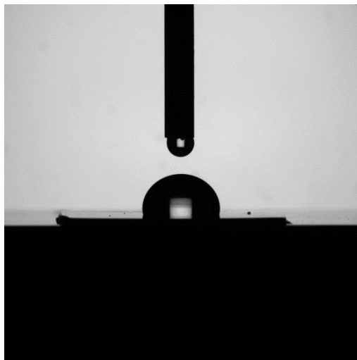
Abb. 1: Messung des Kontaktwinkels von Wasser auf Edelstahl
